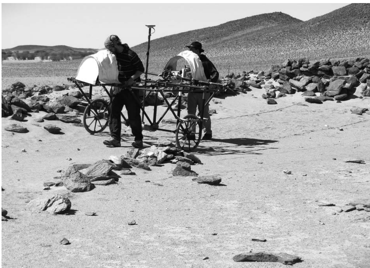
Abb. 2: Messwagen mit 6 Magnetiksonden (Mitte), Navigationsrechner (vorne) und Datenlogger (hinten).
