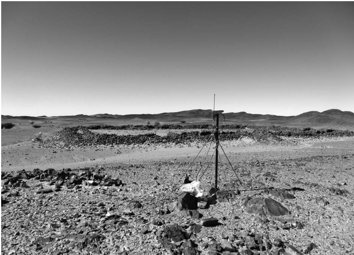
Abb. 3: In der Nähe des Meßfeldes aufgebaute GPS-Basis-Station.
