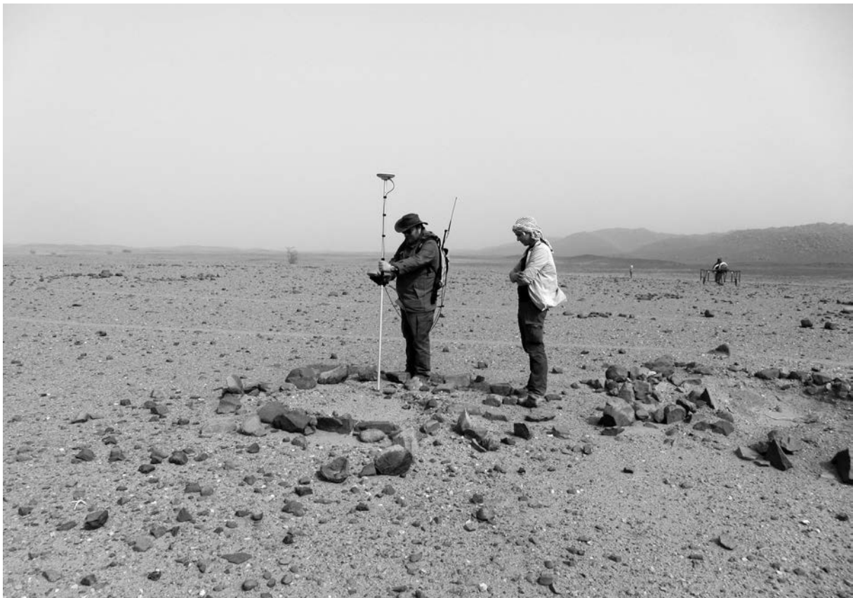
Abb. 11: Einmessung der Oberflächenbefunde am Site 205
