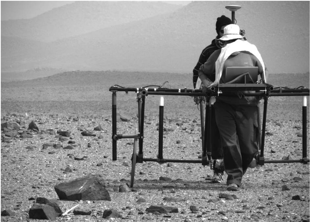
Abb. 10: Geomagnetische Messungen am Site 205.
